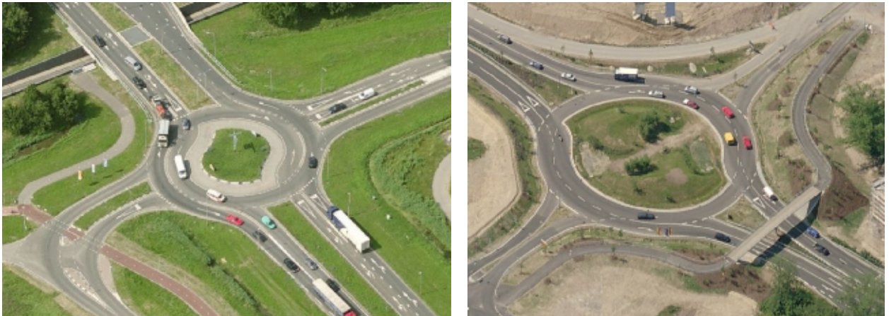
Abb. 2 Beispiele für Turbokreisverkehre: links Rotterdam N 471/Bovendijk, rechts Baden-Baden B 500/Gewerbepark Cité
